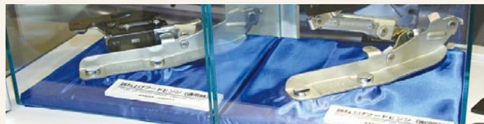
城南製作所は日産「GT-R」向けのボンネット跳ね上げシステムを展示
