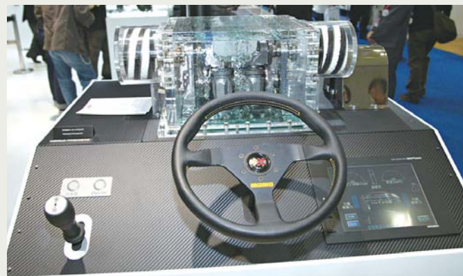
日本精工「左右独立トロイダル CVT」
