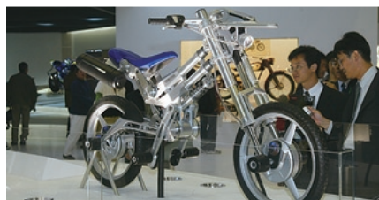
インホイールモーター二輪駆動の電気バイク「DEINONYCHUS」
